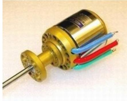
Zur Montage der Verlängerung wird zunächst die Magnetglocke mit Welle vom Motor abgezogen. Sollte dies nicht Gewaltfrei gehen, hilft leichtes Klopfen mit einem Kunststoff-Hammer von vorn gegen die Welle, dabei den Motor am Frontdeckel festhalten.
