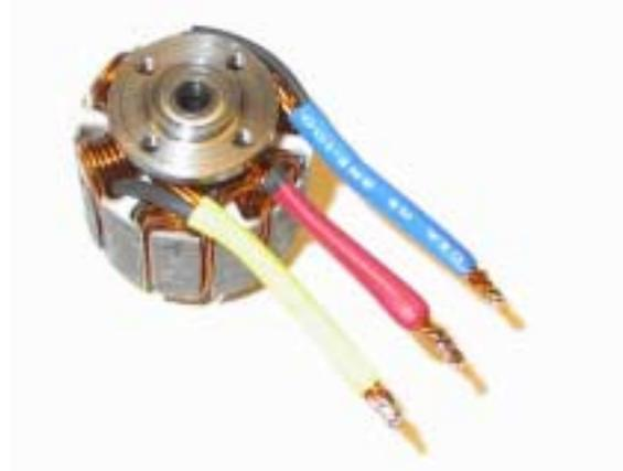
Dénuder avec soin toutes les extrémités des fils sur une longueur d'environ 10 mm, ceci au moyen d'un couteau aiguisé (gratter jusqu'à la disparition de la laque), puis étamer. Les fils qui font partie du même groupe doivent être torsadés et soudés. Courber ensuite les connexions ainsi obtenues jusqu'à ce qu'elles s'adaptent parfaitement aux ouvertures du couvercle avant dans lesquelles ils doivent passer. Fixer ensuite le couvercle avant avec les deux boulons à tête conique joints au kit.
