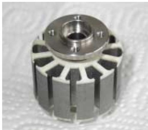
Avant le début du bobinage, il faut encore couper des inserts isolants pour les rainures du stator. Nous recommandons d'utiliser le papier d'isolation résistant à la chaleur livré avec le kit (0,1-0,25 mm épaisseur). La dimension de coupe dépend du diamètre du stator et de sa longueur:
