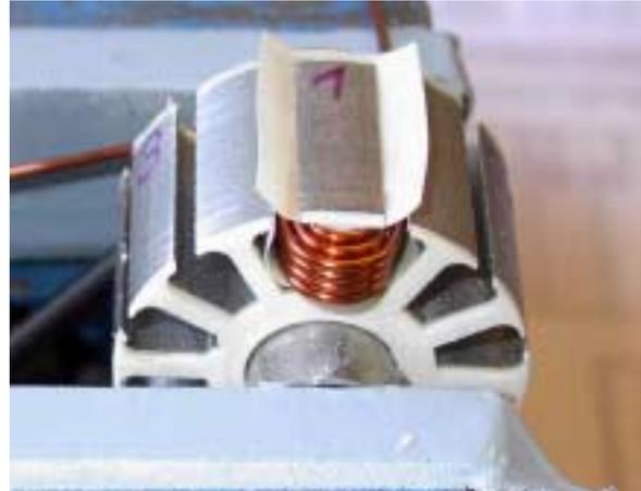
Avant d'effectuer l'avant-dernier ou l'antépénultième tour, l'extrémité du papier isolant, qui dépasse et porte à faux, doit être découpée à ras (rasoir) sur les deux ailettes voisines qui ne reçoivent pas de fil. Les deux bords intérieurs excédentaires sont raccourcis jusqu'à une largeur de 3-4 mm et glissés sous les rebords extérieurs. Le recouvrement de rainures qui en résulte peut être sécurisé encore par de la colle cyanacrylate. Enlever tout de suite tout excédent de colle.
