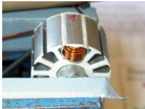
Sortir maintenant le bloc du stator de l'étau et s'occuper de l'autre bout du fil qui était resté libre bien qu'immobilisé autour du collet. Le dérouler. Vérifier la position de la gaine rétractable qui sert de protection au pontage entre les deux ailettes du stator et, si nécessaire, corriger cette position.
