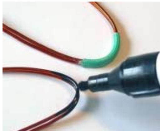
Ce double-fil doit être marqué exactement en son milieu avec un feutre résistant à l'eau et une gaine thermo-rétractable (aussi mince que possible) doit y être fixée (14/20/25 mm) (TM280/350/430). Au lieu de la gaine thermo-rétractable, une gaine d'isolation renforcée peut également être utilisée; sa position doit être fixée avec une goutte de colle cyanacrylate.
